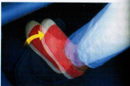
6. Elinduláskor a tengelykapcsoló-pedált a súrlódási pontig gyorsan, majd rövid ideig történő megtartás után lassan engedjük fel.
